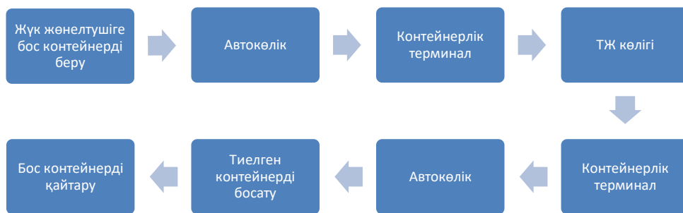
Сурет 1. Жүктерді контейнерлерде тасымалдау кезінде автомобиль көлігінің теміржол көлігімен өзара әрекеттесу схемасы
