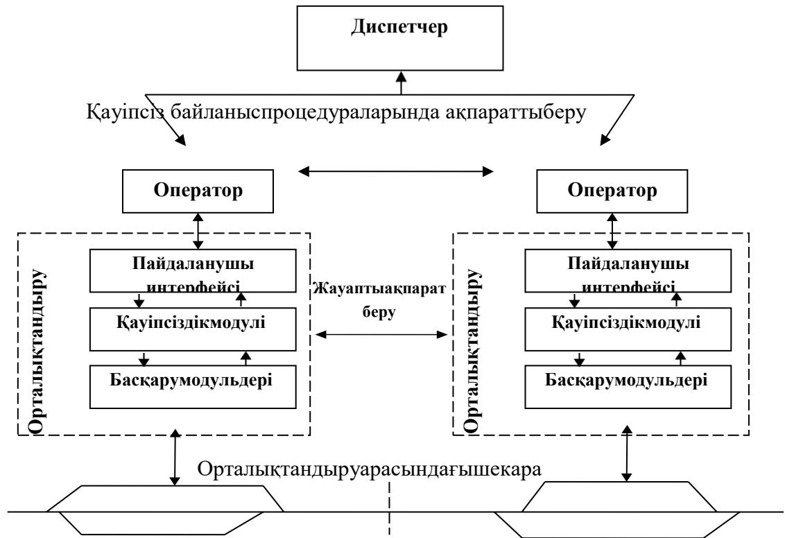
Сурет 2. Пойыздар қозғалысын басқару және қауіпсіздігін қамтамасыз ету жүйесінің функционалдық құрылымы
